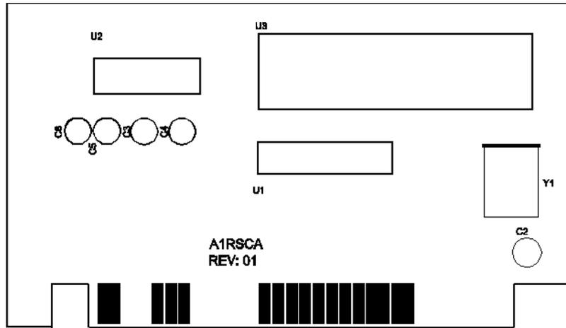
**Fig. 1-12. RSCA Module Layout**
