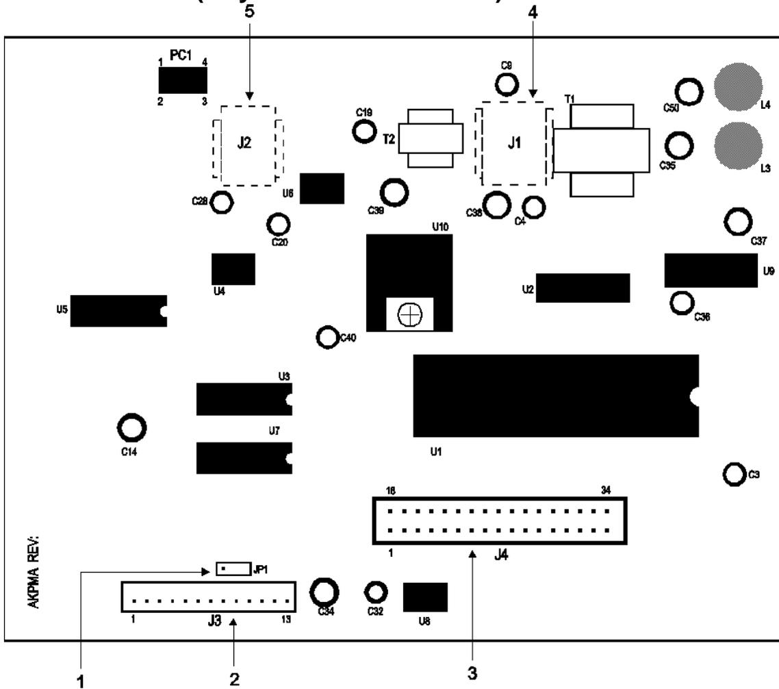
Fig. 1-10. AKPMA Module Layout
