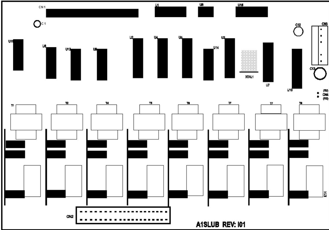
**Fig. 1-11. SLUB Module Layout**
